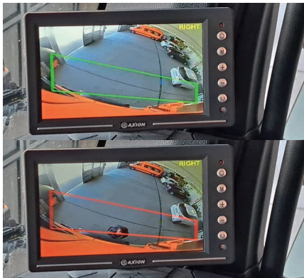
Funktion der neuen Abbiege-Assistenten
