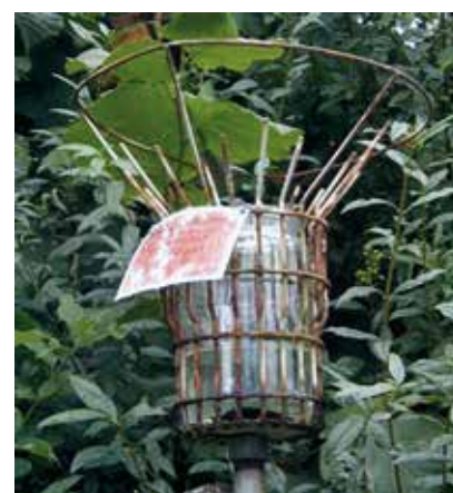
Messpunkt für Staub-Depositionsmessungen im Rahmen des Umweltmonitoring
