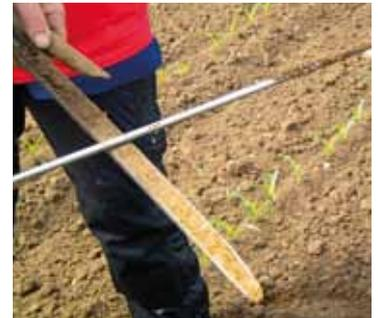
Das Bild zeigt ein Bodenprofil, wie es sich im Bohrstock darstellt: Humoser Boden mit deutlichem Übergang – und geringer Zwischenschicht – in den bleichen Unterboden.
