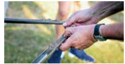
Mit Bohrstöcken wird die Qualität des Bodens ermittelt.
