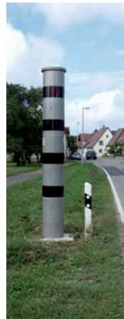
Seither konnten insgesamt sieben neue Messstellen – alle für die Überwachung von beiden Fahrrichtungen – eingerichtet und durch den Alb-Donau-Kreis bezuschusst werden. Alle Kommunen haben sich hier für das neue, laserbasierte Messsystem der Firma Vitronic entschieden. Grundlage dieses Systems ist die neue LIDAR-Technologie. Dabei wird ein scannender Laser eingesetzt, der die Geschwindigkeiten und Positionen
