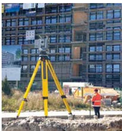
Für die im Bereich der Ingenieurvermessungen oft verlangte hohe Messgenauigkeit wurde 2019 für den Fachdienst Vermessung eine Robotic-Totalstation beschafft. Dieses Instrument kennzeichnet u.a. aus, dass es mittels Funk gesteuert wird. Es sucht selbständig nach dem dazugehörigen Reflektor beim Bearbeiter. Die Messungen werden über ein feldtaugliches Tablet aus der Ferne ausgelöst.
