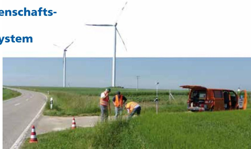
Überprüfung eines Vermessungspunkts und Bestimmung ETRS89/UTM Koordinaten bei Neenstetten.
