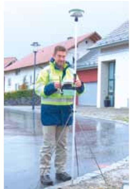
Antenne mit Steuerungsrechner zur GPS-Messung.
