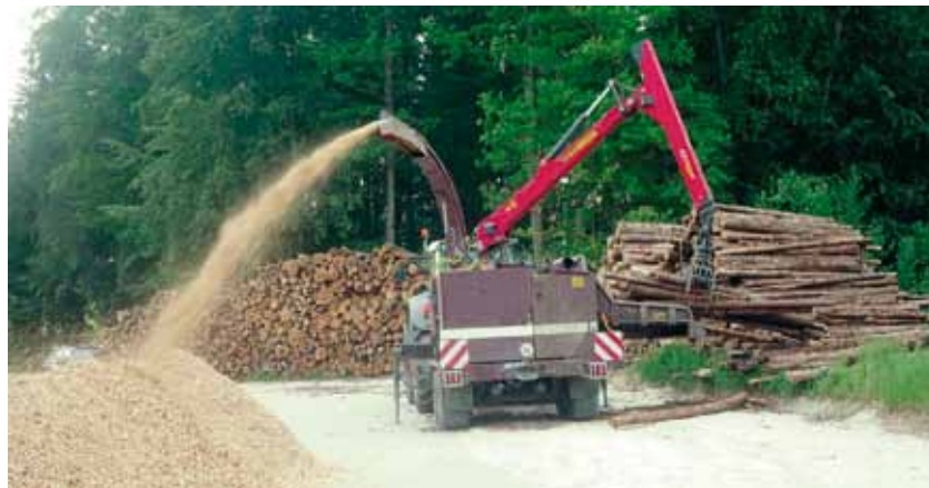
Hacken von Energieholz für die Heizzentrale beim Beruflichen Schulzentrum in Ehingen auf einem Lagerplatz bei Ringingen.
