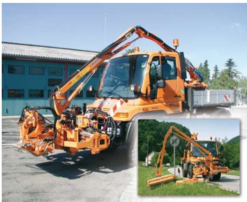
Moderne Mähvorrichtung am Unimog.
