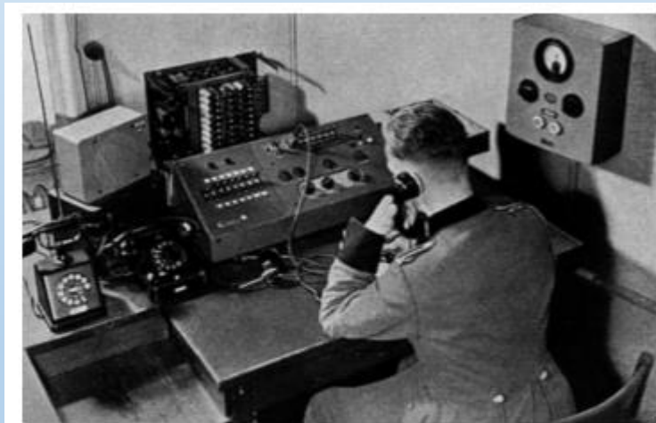
Vermittlung zur Überleitung von Funkgesprächen aus dem 1943 in Hamburg errichteten Polizeifunknetz in das Fernsprechnetz.
