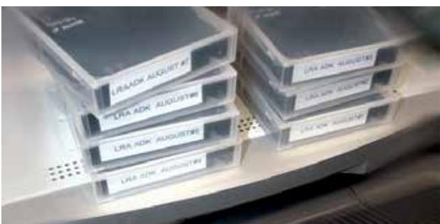
Das gesamte Speichervolumen des Landratsamtes umfasst derzeit ca. 17 Terabyte (17.000 Gigabyte), die Platz auf sechs handlichen Magnetbändern finden. Die IT-Administratoren kontrollieren täglich den in der Nacht durchgeführten Sicherungslauf auf Auffälligkeiten.
